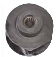
Nadellager im Lastkettenrad
