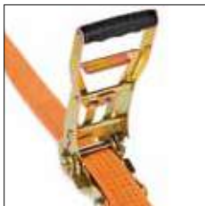
Langhebelratsche mit feinverzahntem Doppelkranz-Zahnrad und Vorrichtung zum dosierten Lösen. Sicherung gegen kippende Ladung.
