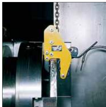
Tigrip-Allzweckgreifer als Sonderkonstruktion mit geringen Baumaßen für den Einsatz an schwer zugänglichen Stellen (z. B. Drehbank).
